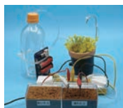
自動栽培 (土の水分量に合わせてポンプが稼働)
